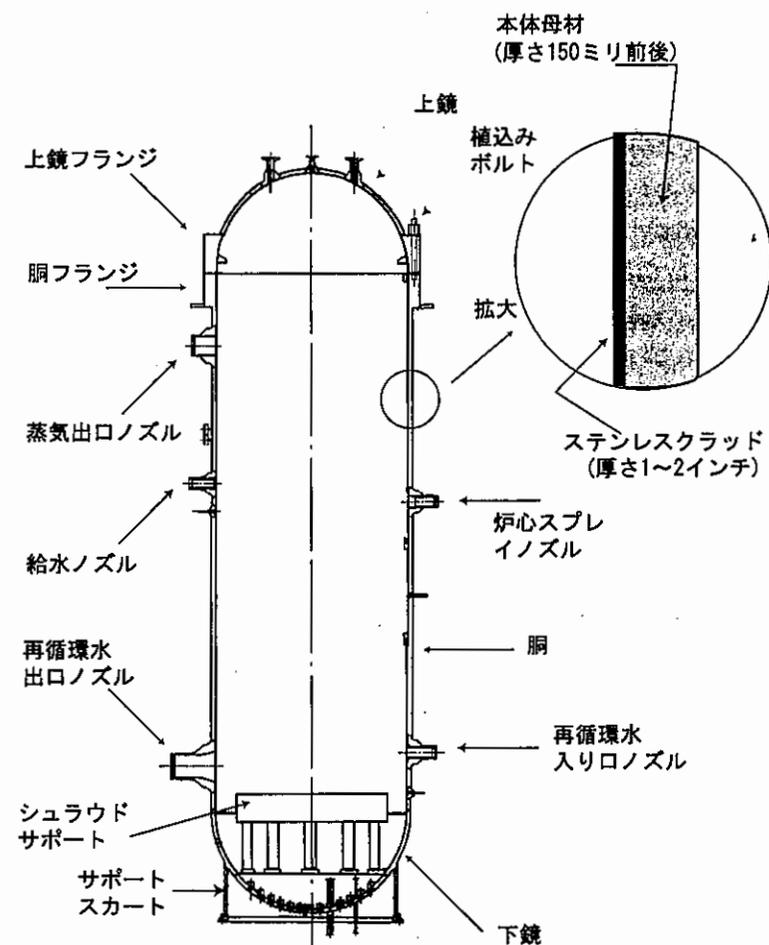
図 3.1 初期の沸騰水型原子炉压力容器
