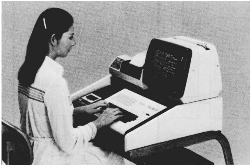
図表3-4 1978年、日立製作所が発売した国産第一号のパソコン「ベーシックマスター」。その機能は、プログラムの作成、家庭用カセットテープレコーダを用いたプログラムの保存、文字（英数字、カタカナなど）や図形の表示といったものに限られていた。
