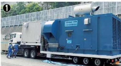
① 空冷式非常用発電装置(4台) 約1,825kVA/台
